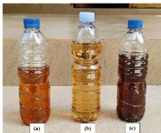
Gambar 6. (a). Cara sederhana mengetahui air yang mengandung zat besi dan mangan menggunakan air teh, (b). Air yang tidak mengandung zat besi dan mangan dan (c). Air yang mengandung zat besi dan mangan.
