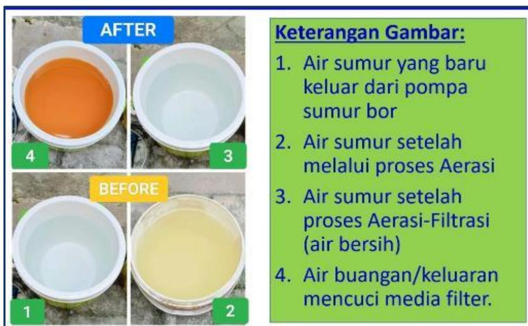
Gambar 7. Air yang belum diolah dan air yang telah diolah dengan metode aerasi-filtrasi
