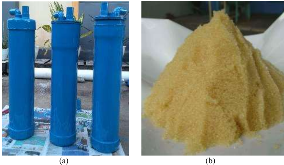
Gambar 1. Alat dan bahan filter resin penukar kation yang terdiri dari: (a) tabung filtrasi dan (b) resin penukar kation
