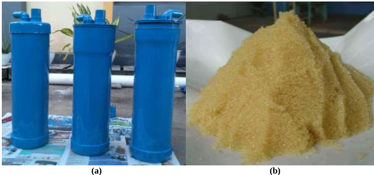
Gambar 1. Desain alat dan bahan filter resin penukar kation: (a) Tabung filtrasi, (b) Resin penukar kation
